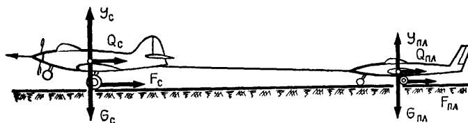
Рис. 109 Взлет аэропоезда
