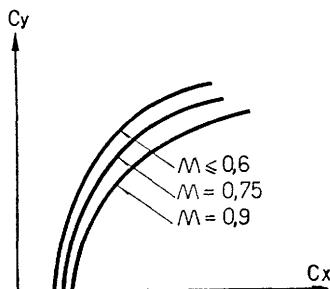
*Рис. 46 Поляры самолета для различных чисел  $M$*
