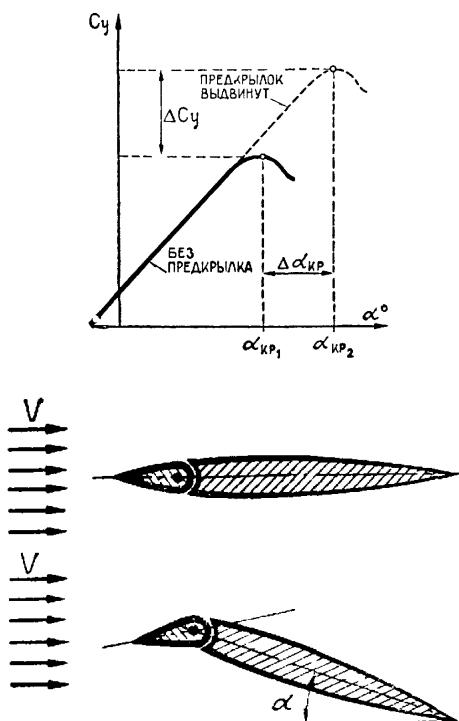
*Рис. 54 Кривая  $C_y = f(\alpha)$  для крыла с предкрылками*
