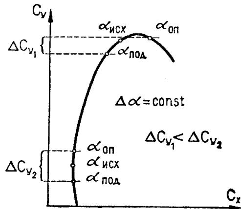
Рис. 144 Изменение коэффициента  $C_y$  при нарушении поперечного равновесия на различных углах атаки
