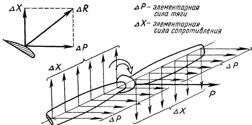
Rис. 66 Аэродинамические силы воздушного винта
