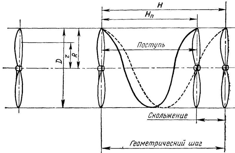
Рис. 63 Диаметр, радиус, геометрический шаг воздушного винта
