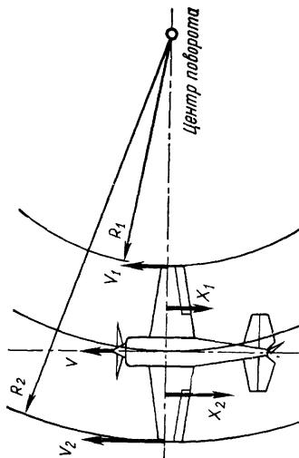
*Рис. 183 Уравновешивание противодействующих виражу моментов рулем направления*
