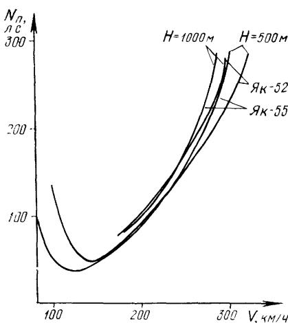
*Рис. 82 Кривые мощностей, потребных для горизонтального полета*
