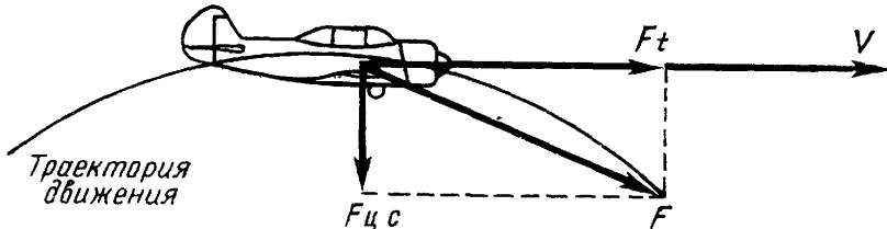
*Рис. 169 Искривление траектории центростремительной силой  $F_{ц.c}$*
