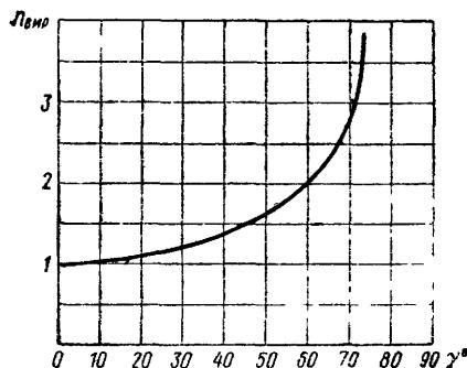
Рис. 179 Зависимость перегрузки на вираже от крена
