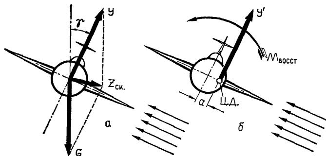
Рис. 142 Восстановление поперечного равновесия при скольжении самолета
