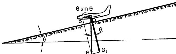
Рис. 107 Взлет самолета с наклонной ВПП
