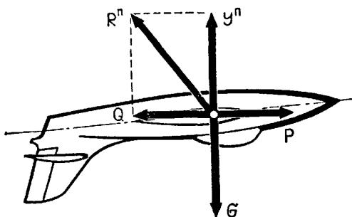
*Рис. 206 Схема сил в горизонтальном перевернутом полете*
