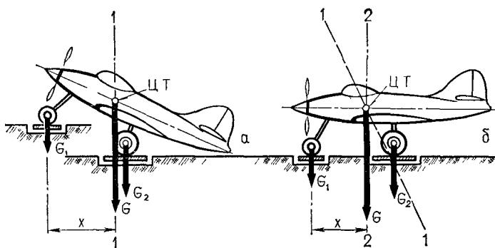
Рис. 119 Определение центра тяжести самолета методом взвешивания
