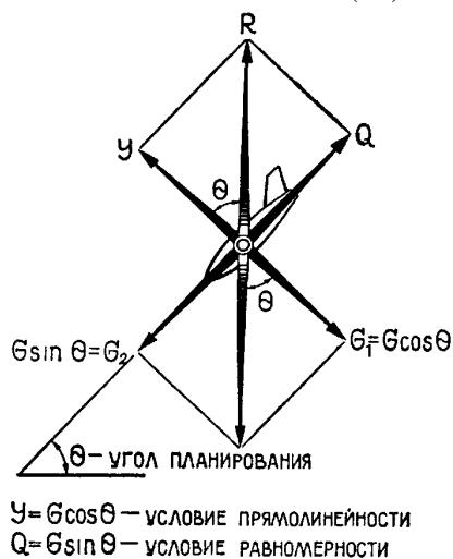
Рис. 96 Схема сил, действующих на самолет при планировании
