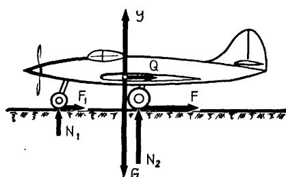
Рис. 116 Схема сил, действующих на самолет при пробеге
