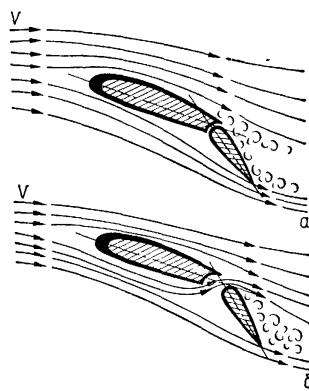
Рис. 47 Профиль крыла со щитком, смещающимся назад
