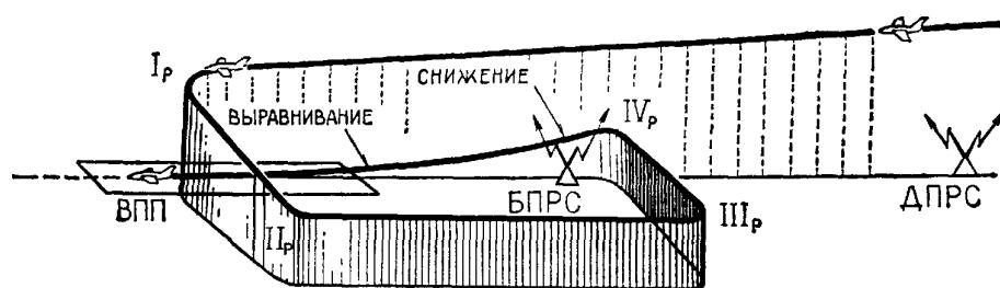
Рис. 114 Схема "круга" над аэродромом перед посадкой
