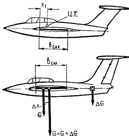
Рис. 31 Положение центра тяжести самолета
