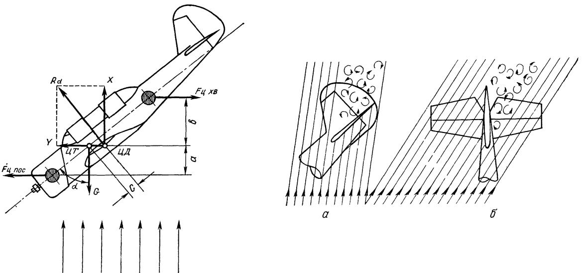
*Рис. 166 Схема сил, действующих на самолет при выполнении штопора. Влияние инерционных сил разнесенных грузов*
