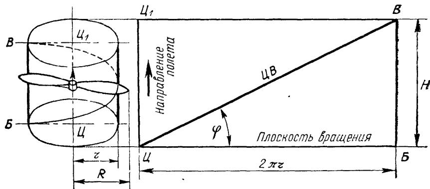
Рис. 64 Развёртка винтовой линии
