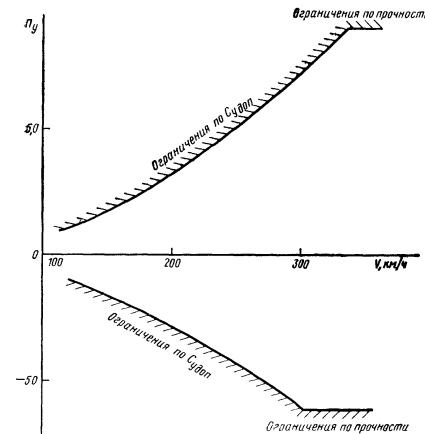
Рис. 176 Располагаемые перегрузки самолета Як-55 при  $H=1000$  м
