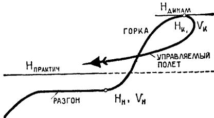
Рис. 94 Подъем самолета на динамический потолок
