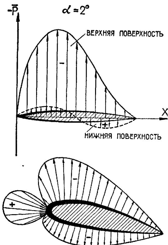
*Рис. 21 Распределение давлений по профилю крыла*
