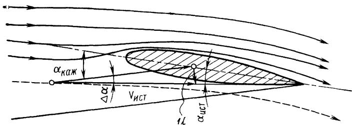
Рис. 35 Отклонение воздушного потока вниз, вызванное вихревым шнуром
