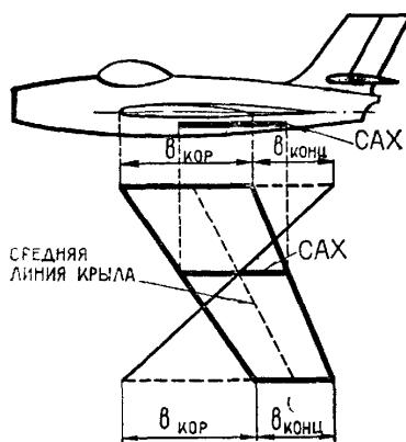
Рис. 30 Геометрическое определение CAx
