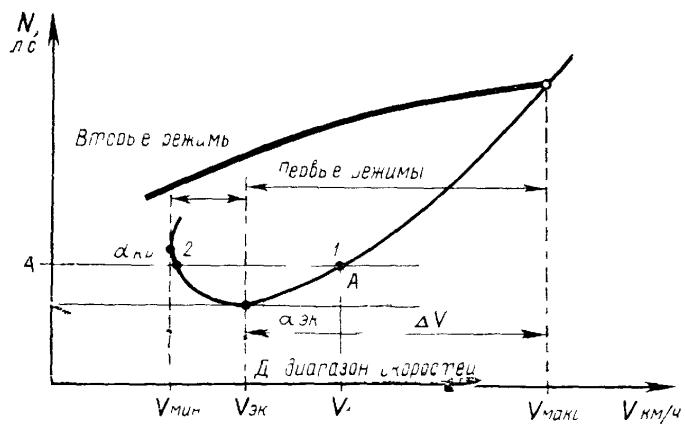
*Рис. 85 Первые и вторые режимы и диапазоны скоростей горизонтального полета*
