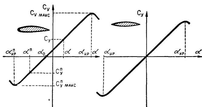
Рис. 200 Кривые  $Cy = f(a)$  профилей: а - несимметричного; б - симметричного
