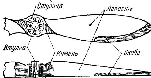
Рис. 60 Воздушный двухлопастный винт неизменяемого шага
