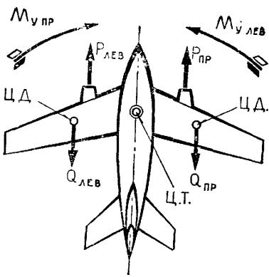
*Рис. 152 Схема сил и моментов, действующих на самолет относительно оси Y*
