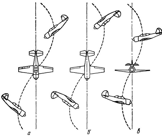
Рис. 158 Штопор самолета: а - прямой; б - обратный; в - плоский
