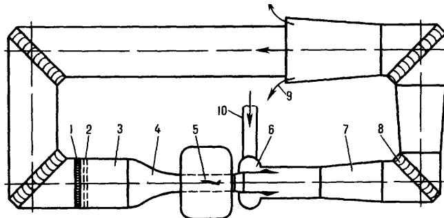
*Рис. 13 Схема баллонной трансзвуковой эжекторной аэродинамической трубы*
