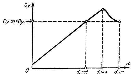
Рис. 164 Соотношение подъемных сил опускающегося и поднимающегося полукрыльев при установленном самовращении
