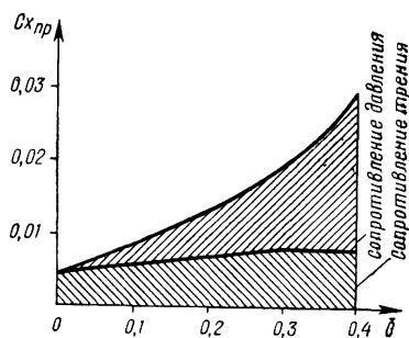
*Рис. 33 График зависимости профильного сопротивления от толщины профиля*
