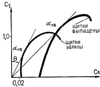
Рис. 51 Поляра самолета с убранными и выпущенными щитками
