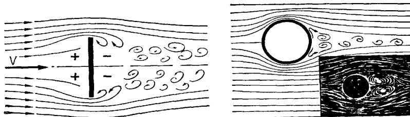
Рис. 17 Аэродинамический спектр плоской пластиинки и шара
