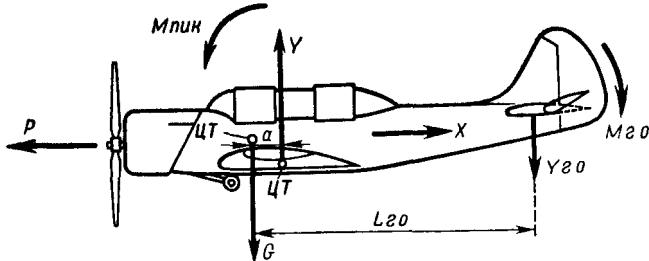
*Рис. 126 Условия продольного равновесия самолета в горизонтальном полете*
