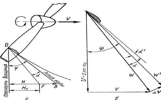
**Рис. 65 Угол установки и угол атаки лопастей: а - угол атаки элемента лопасти, б - скорости элемента лопасти**
