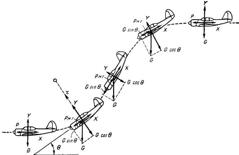
Рис. 188 Схема сил, действующих на самолет при пикировании
