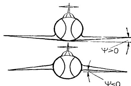
Рис. 23 Угол поперечного V крыла
