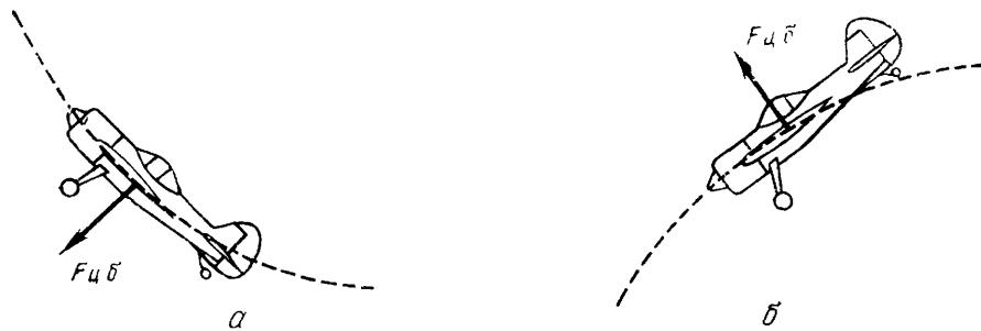
*Рис. 174 Действие центробежной силы инерции на летчика а - при резком увеличении угла атаки, б - при резком уменьшении угла атаки*
