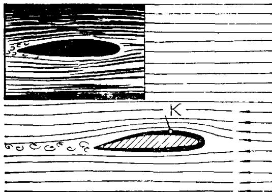
*Рис. 19 Аэродинамический спектр удобообтекаемого несимметричного тела (профиля крыла)*
