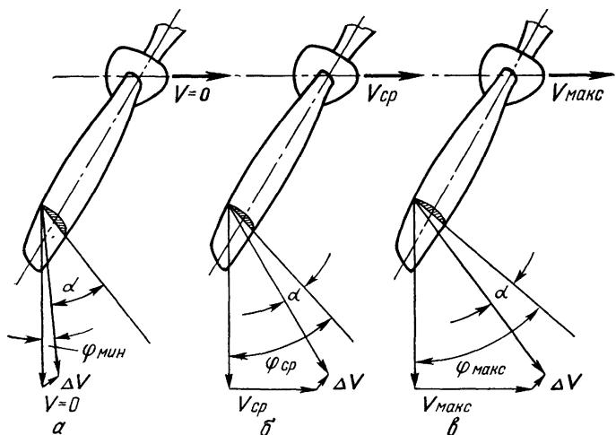
Рис. 73 Работа воздушного винта изменяемого шага B530ТА-Д35 при разных скоростях полета
