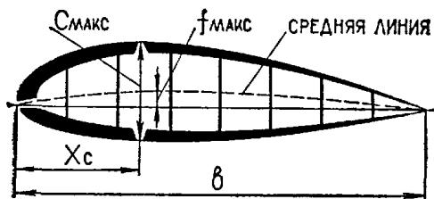
Рис. 26 Геометрические характеристики профиля:
