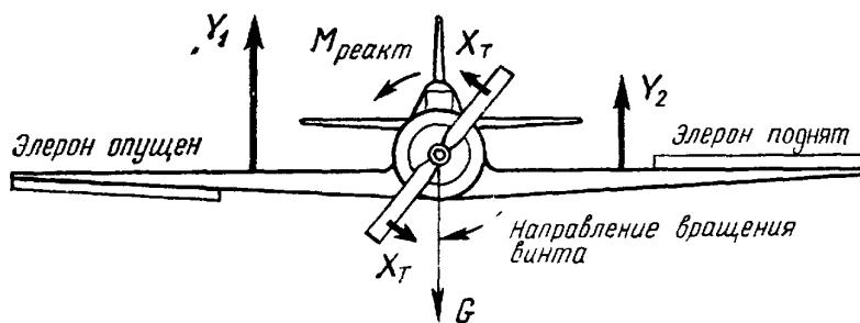
Рис. 139 Реактивный момент воздушного винта и уравновешивание его методом отклонения элеронов
