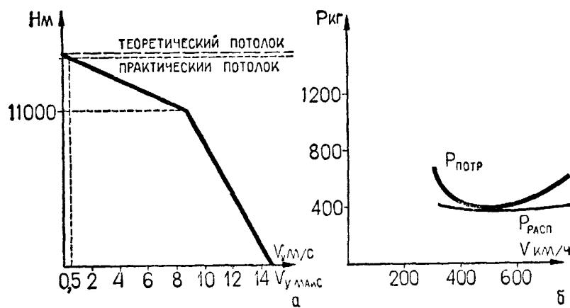
Рис. 93 К определению потолка самолета: а - график зависимости  $V_y$  от высоты полета; б - кривые потребных и располагаемых тяг на теоретическом потолке
