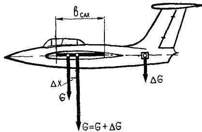
Рис. 121 Расчет центровки при изменении веса самолета
