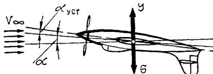
*Рис. 201 Влияние угла установки крыла на угол между продольной осью самолета и горизонтом*
