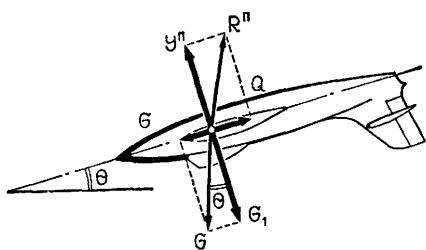
*Рис. 208 Схема сил при планировании в перевернутом положении*
