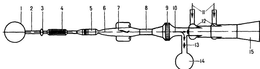
*Рис. 15 Схема баллонной гиперзвуковой аэродинамической трубы*
