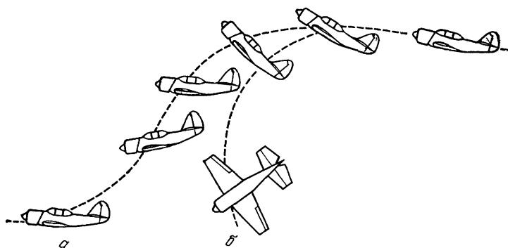
*Рис. 160 Потеря скорости в горизонтальном полете: а - падение на нос с переходом в пикирование, б - падение на крыло с переходом в пикирование или штопор*
