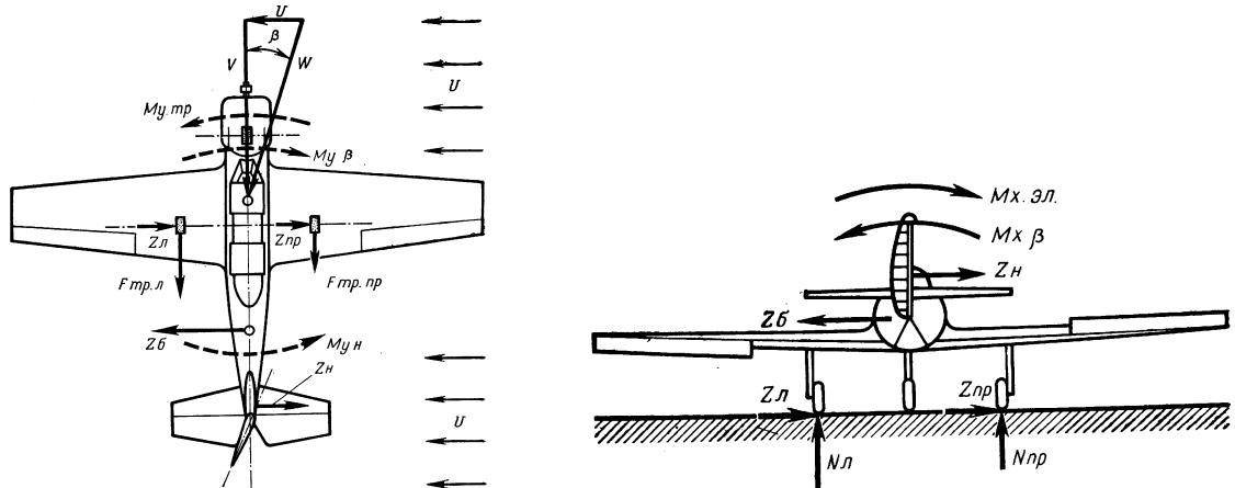
Рис. 110 Схема сил, действующих на самолет Як-52 при разбеге с боковым ветром
