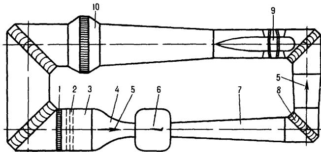
*Рис. 12 Схема дозвуковой компрессорной аэродинамической трубы.*
