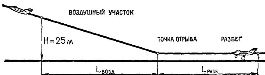
Рис. 105 Схема взлета самолета
