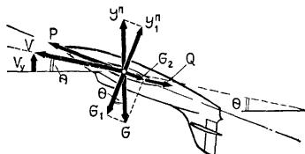
*Рис. 207 Схема сил при подъеме в перевернутом полете*
