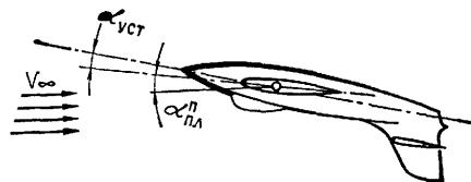
*Рис. 209 К определению угла наклона продольной оси*
