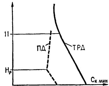
Рис. 220 Зависимость  $C_{k \text{ мин}}$  от высоты полета для самолетов с ТРД и ПД
