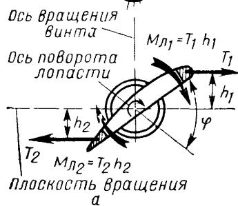
*Рис. 75 а - характер действия на лопасть воздушного винта центробежных сил лопасти, б - аэродинамические силы, действующие на винт*
