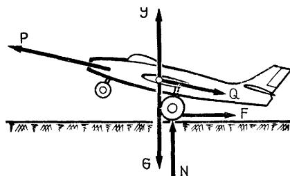
*Рис. 106 Схема сил, действующих на самолет на разбеге*
