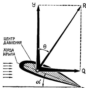
Рис. 28 Полная аэродинамическая сила и точка ее приложения
