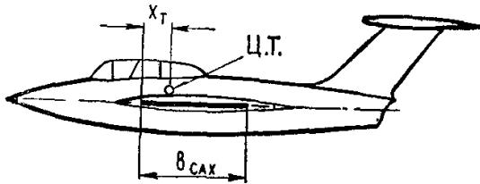
Рис. 120 Положение центра тяжести самолета
