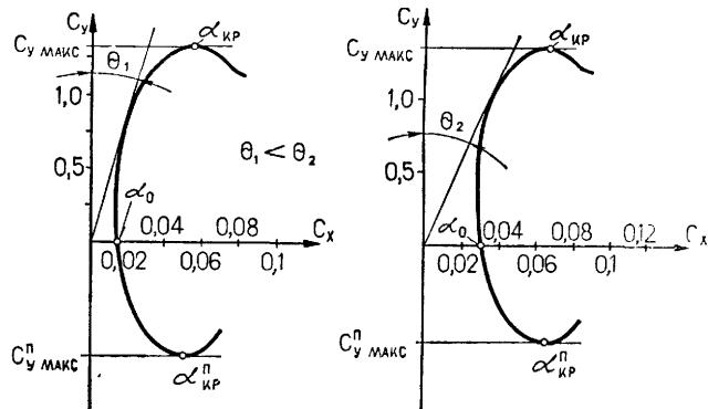
Рис. 202 Поляра крыла и самолета
