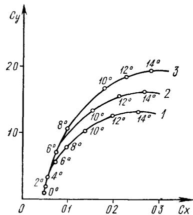
Рис. 76 . Поляра самолета с учетом обдувки воздушным винтом
