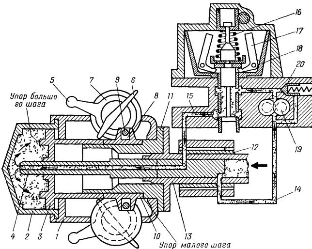
*Рис. 77 Схема работы воздушного винта на равновесных оборотах*
