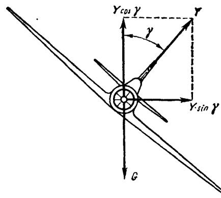
Рис. 178 Схема сил, действующих на самолет на вираже (вид спереди)
