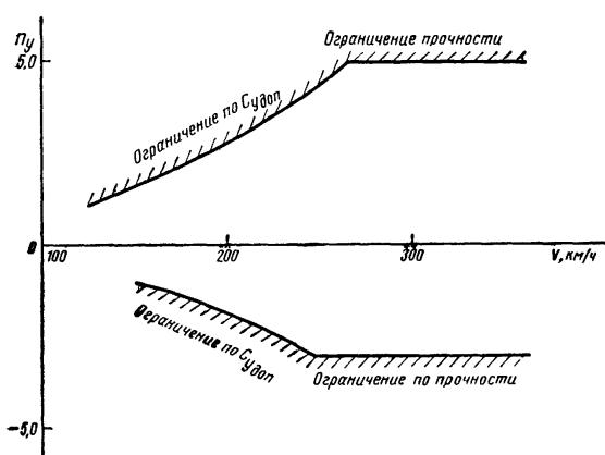
Рис. 175 Располагаемые перегрузки самолета Як-52 при  $H=1000$  м
