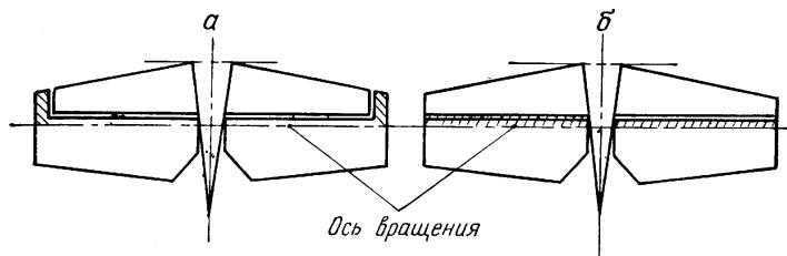
Рис. 127 Виды аэродинамических компенсаций: а - роговая; б - осевая
