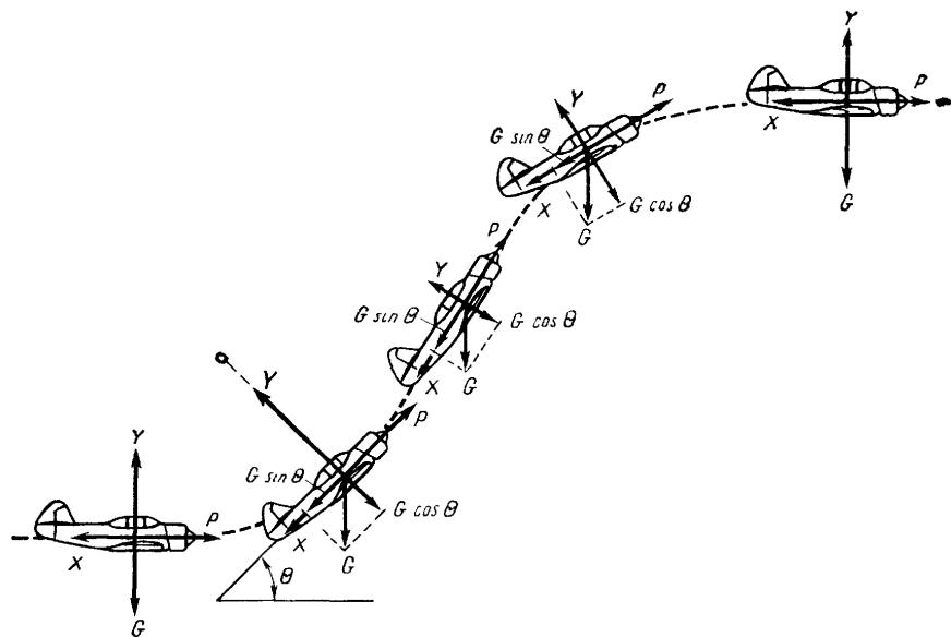
Рис. 189 Схема сил, действующих на самолет на горке
