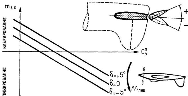
Рис. 204 График  $m_z = f(C_y^P)$  для перевернутого полета
