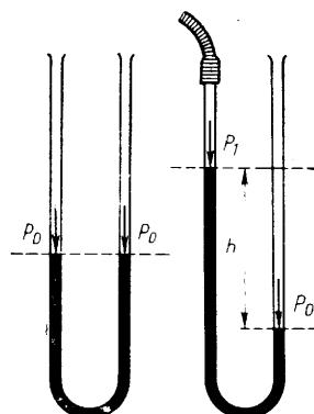
Рис. 3 Манометр
